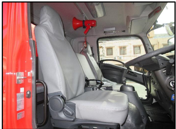
「AMT車」 クラッチ操作が不要で運転操作の負担を 軽減し、自ラシフトチェンジも可能
