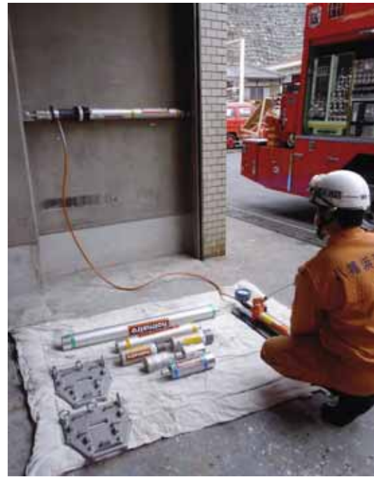
金属等を切断したり押し広げたりできる油圧救助器具
