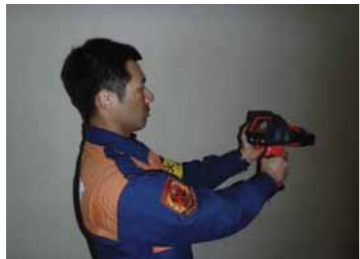
埋もれている人のわずかな呼吸、動きでも検知できる電磁波探査装置
