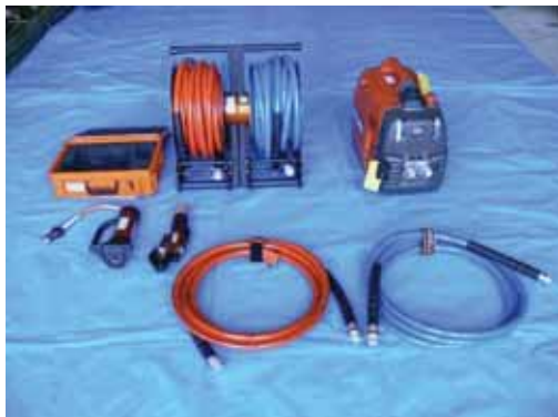
金属等を切断したり押し広げたりできる油圧救助器具
