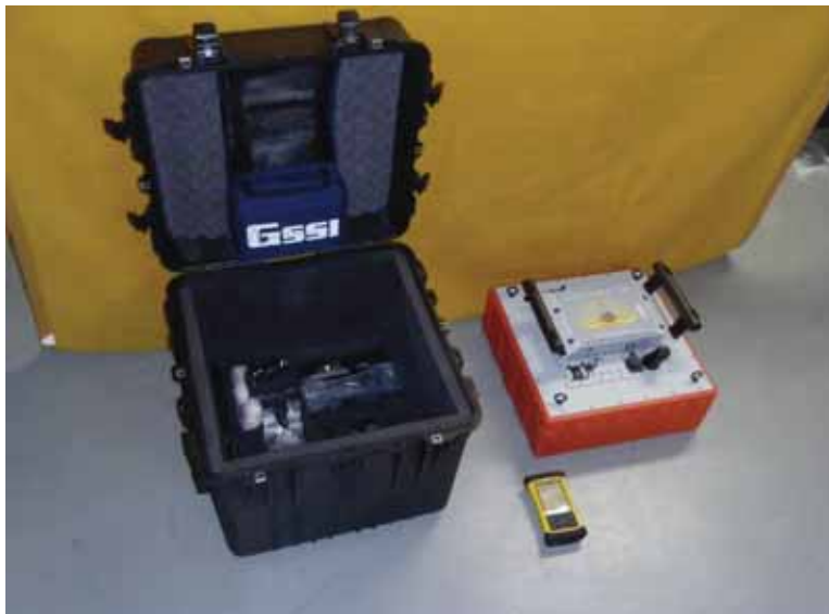
埋もれている人のわずかな呼吸、動きでも検知できる電磁波探査装置
