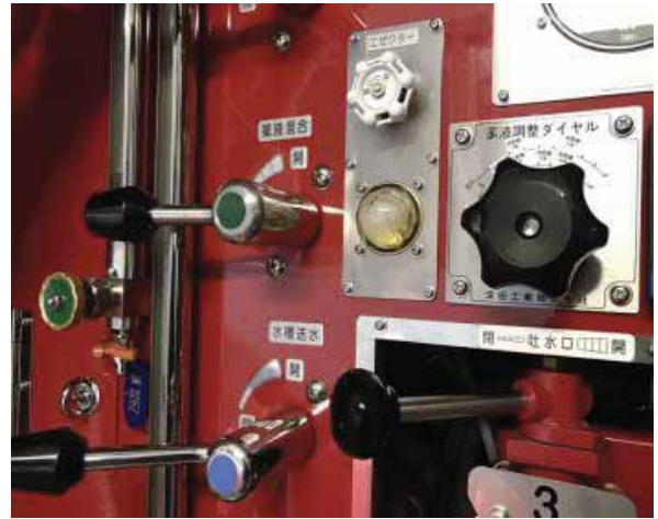
ポンププロポーションナー クラスB火災事案にも万全の装備
