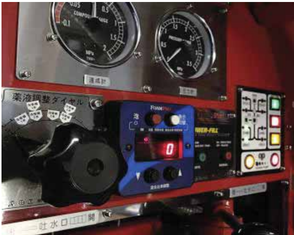
自動泡混合装置(フォームプロ) ワンタッチでクラスA泡消火薬剤が使用可能
