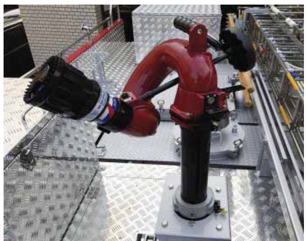
クロスファイヤー放水銃 放水距離は最大約60m
