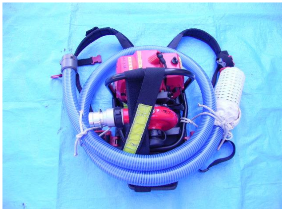
自動吸水装置付可搬ポンプ
