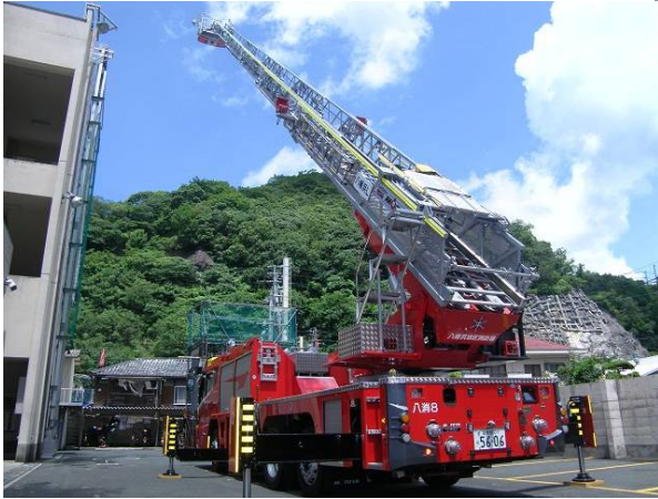
梯子を起伏・伸梯させた状況
