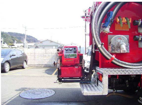
昇降式の可搬ポンプ積載器具
