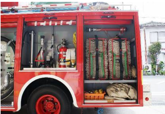
吸水・送水装置・消火器及びホースを装備
