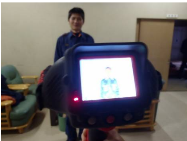
暗闇や火災の煙等で動けない人の熱を感知することができる熱画像直視装置
