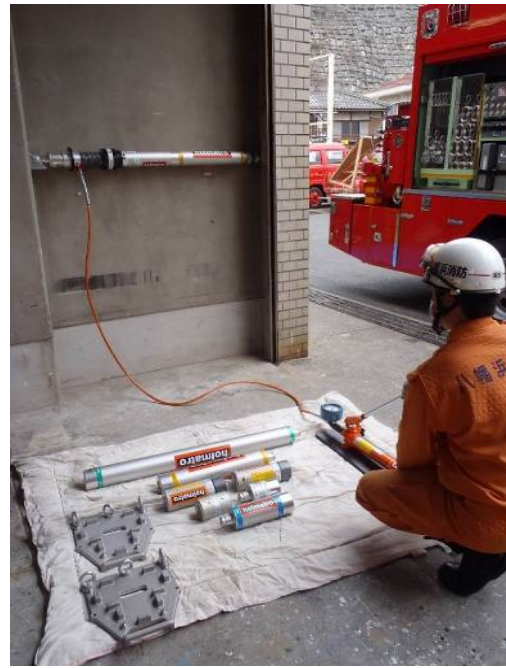
金属等を切断したり押し拡げたりできる油圧救助器具
