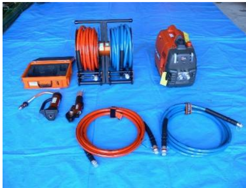
金属等を切断したり押し拡げたりできる油圧救助器具
