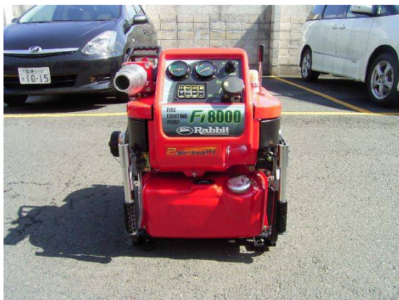
自動吸水装置付可搬ポンプ
