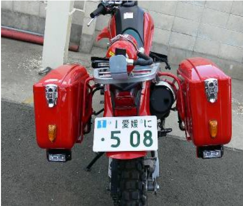
車両後部両サイドに収納ボックス、LED赤色灯を装備している。
