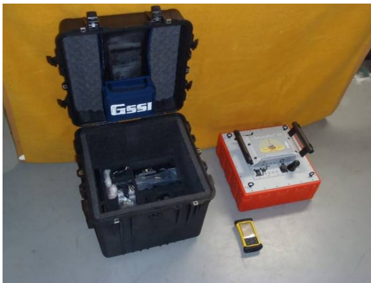
埋もれている人のわずかな呼吸、動きでも検知できる電磁波探査装置
